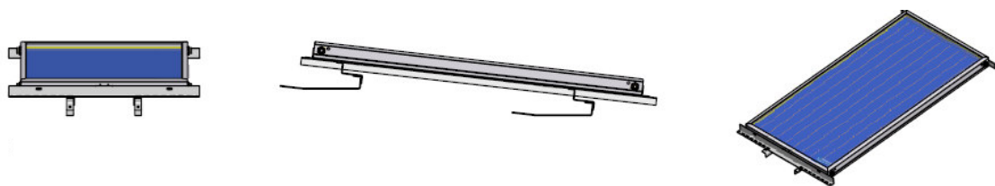
Suport pentru fixarea unui singur panou solar pe acoperisuri inclinate sub acelasi unghi cu cel al acoperisului (0°). (09140030)
